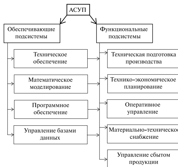
Рис. 2. Модель взаимосвязи обеспечивающих и функциональных подсистем АСУП
